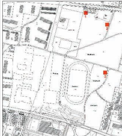
Zur Erkundung der Verhältnisse am Standort sollen sowohl die Verfügbarkeit von Grundwasser, als auch der tiefere Untergrund untersucht werden. Zur Ermittlung der Grundwassererfüllbarkeit werden im nördlichen Stadtpark zwei Grundwasserstellen mit einer Tiefe von voraussichtlich etwa 20 m errichtet. Bei positivem Befund werden an diesen Messstellen im April Pumpversuche durchgeführt und die Qualität des Grundwassers untersucht.
